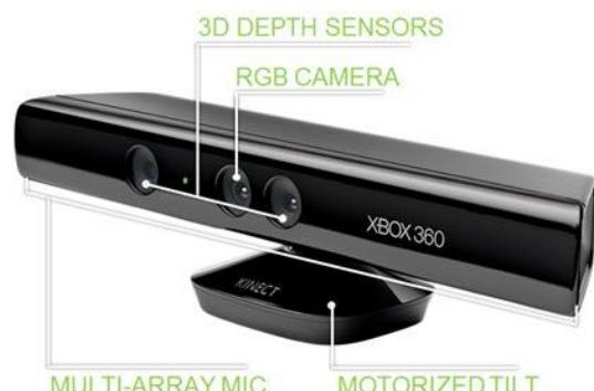
而 Kinect 感應器主要是使用 3D 深度影像(透過上圖左右兩顆鏡頭 - 紅外線發射器及紅外線 CMOS 攝影機)的技術來取得人體動作。
